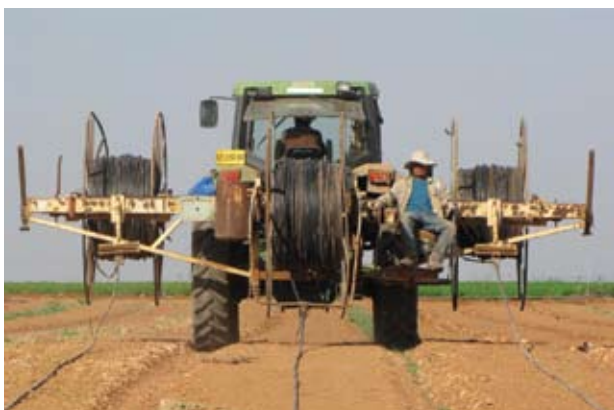
Трехкатушечная установочная машина, 13,000 - 20,000 м
