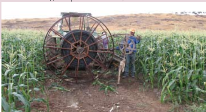
Гидравлический механизм для разборки линии, барабан 2.0 м
